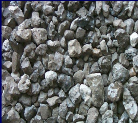
Steel slag waste
